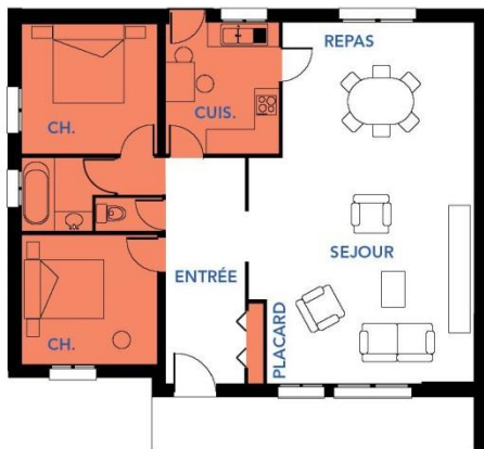
Emplacements interdits (extrait du guide pratique de SÉQUÉLEC sur les branchements individuels à puissance limitée)
